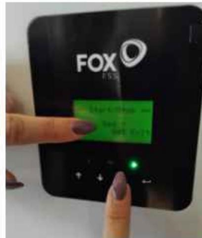
7. Ihr Wechselrichter wird hochgefahren. Es erscheint ein Countdown von 60 Sekunden, der runterzählt. In der Zeit versucht Ihr Wechselrichter sich neu zu verbinden. Ein klackern ist zu hören (das ist normal, da die Relais sich zuschalten).
